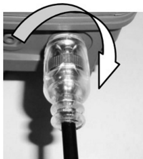
Otočením zástrčky o ¼ otáčky uzavřete spojení
