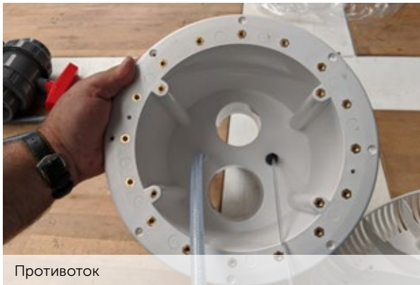
Выход переключающего шланга из корпуса противотока через редуктор к защитному шлангу
