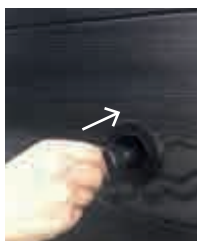
7. ... a zatlačte ventil dovnitř
